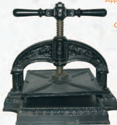
Presse trouvée chez un ferrailleur. Elle ne porte pas le nom du fabricant mais seulement, en relief sous le socle : "Ed. O. à Paris". Elle pèse 16 kg (Collection particulière).
