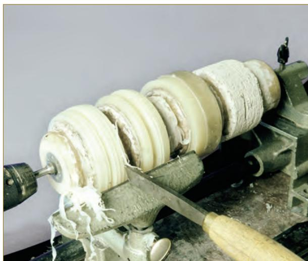
Fig. 64 - Expérimentation : cylindre en argile et modèles en cire.
