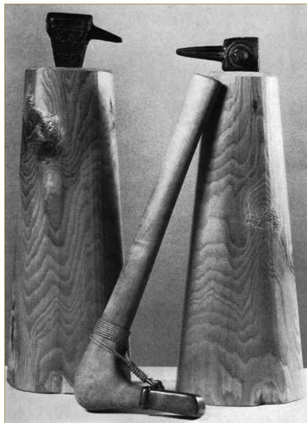
Fig. 40 - Enclumes mises en place dans des billots et marteau à douille emmanché (d'après Wyss 1967, fig. 1).
