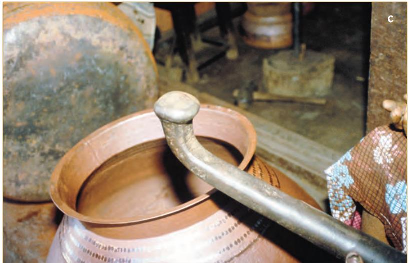
Fig. 50 - Têtes-de-serpent : a. En bronze de Crète (d'après Hundt 1986) ; b. et c. Utilisée par un dinandier en Inde du Sud.
