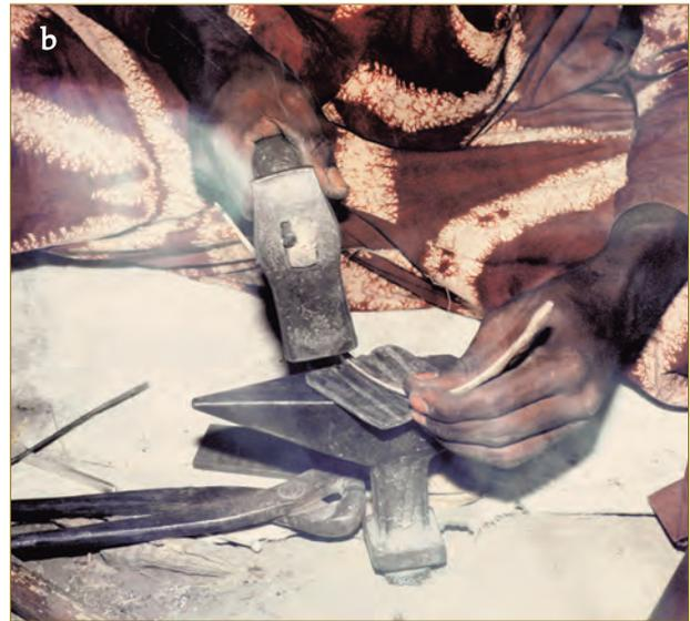
Fig. 75 - a. Martelage de fils dans un atelier d'orfèvrerie au Mali ; b. Utilisation du cambroir pour obtenir un fil de section plano-convexe.
