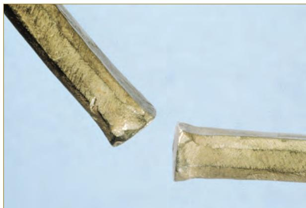
Fig. 73 - Détails de l'ébauche de Monte Airoso, Portugal, avec des facettes de martelage.
