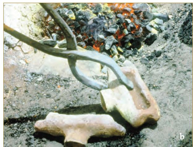
Fig. 22 - Coulée à la cire perdue au Mali actuel : a. Modèle en cire et produit fini ; b. Moules de coulée en terre cuite et four en arrière-plan.
