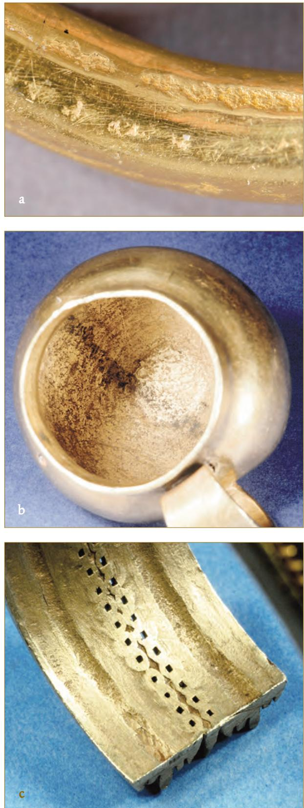
**Fig. 6** - Stigmate de la coulée, la surface est rugueuse : a. Tige en cours de martelage ; b. Intérieur d'un gobelet de Caldas de Reyes, Espagne (Bronze moyen) ; c. Intérieur d'un bracelet de Villena, Espagne (Bronze final).
