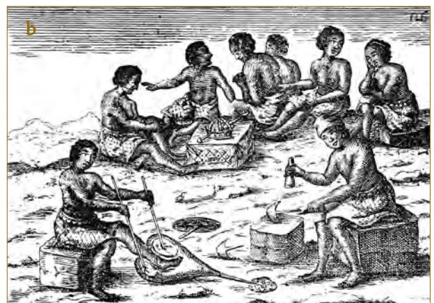
Fig. 11 - Exemples de documents ethnoarchéologiques : a. Utilisation du soufflet à double peau en Afrique (d'après Weule 1908, pl. 20, 2) ; b. Forgeron avec marteau et enclume en pierre ("The kings of Angola", Chronique Cavazzi de 1687, d'après Calegari, Pezzoli 1986, 14).
