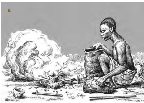
Fig. 11 - Exemples de documents ethnoarchéologiques : a. Utilisation du soufflet à double peau en Afrique (d'après Weule 1908, pl. 20, 2) ; b. Forgeron avec marteau et enclume en pierre ("The kings of Angola", Chronique Cavazzi de 1687, d'après Calegari, Pezzoli 1986, 14).
